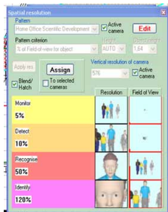
Rys. 10. Kryteria rozdzielczości przestrzennej zgodne z PN-EN 50132-7
