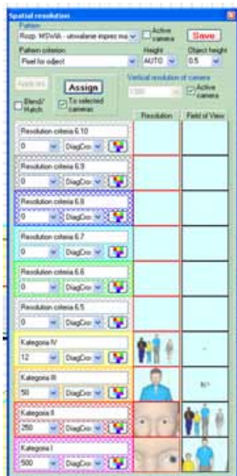
Rys. 1. Definiowanie kryteriów rozdzielczości przestrzennej – kategorie I do IV wg rozporządzenia MSWiA w sprawie utrwalania imprez masowych
