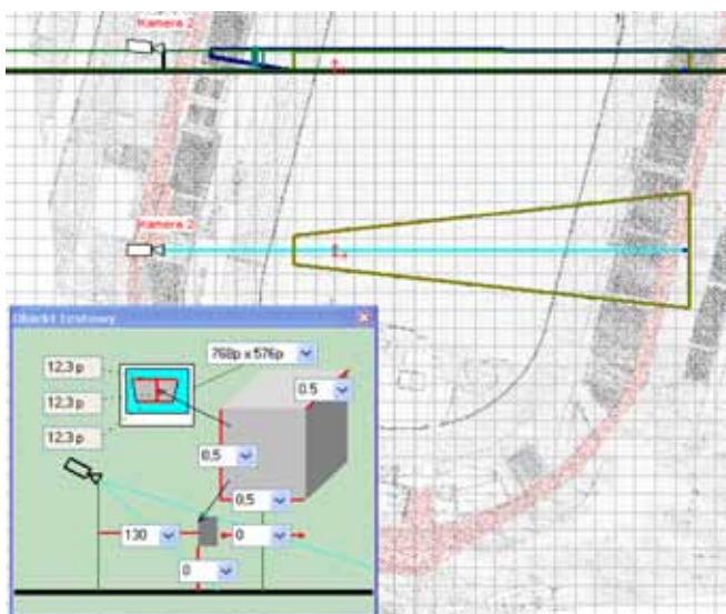
Rys. 1. Ocena zgodności pola widzenia z kategorią IV dla obserwowanego obszaru (w rzucie poziomym) z jednoczesną oceną głębi ostrości (w rzucie pionowym)
