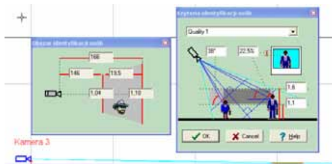
Rys. 8. Ocena skuteczności identyfikacji za pomocą kamery z obiektywem motorzoom f = 500 mm dla obiektu testowego rotakin umieszczonego na trybunie po przeciwnej stronie stadionu
